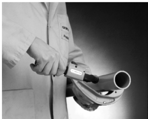
Cięcie rury na odpowiednią długość
